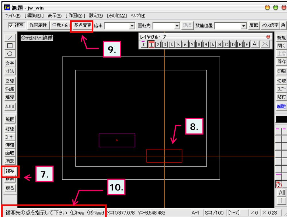
7. ツールバー「編集(1)」の複製ボタンをクリックします。(メニューバー 編集(E) 図形複写(Z)又は、keyボード上の「C」キーを押しても選択できます。)
