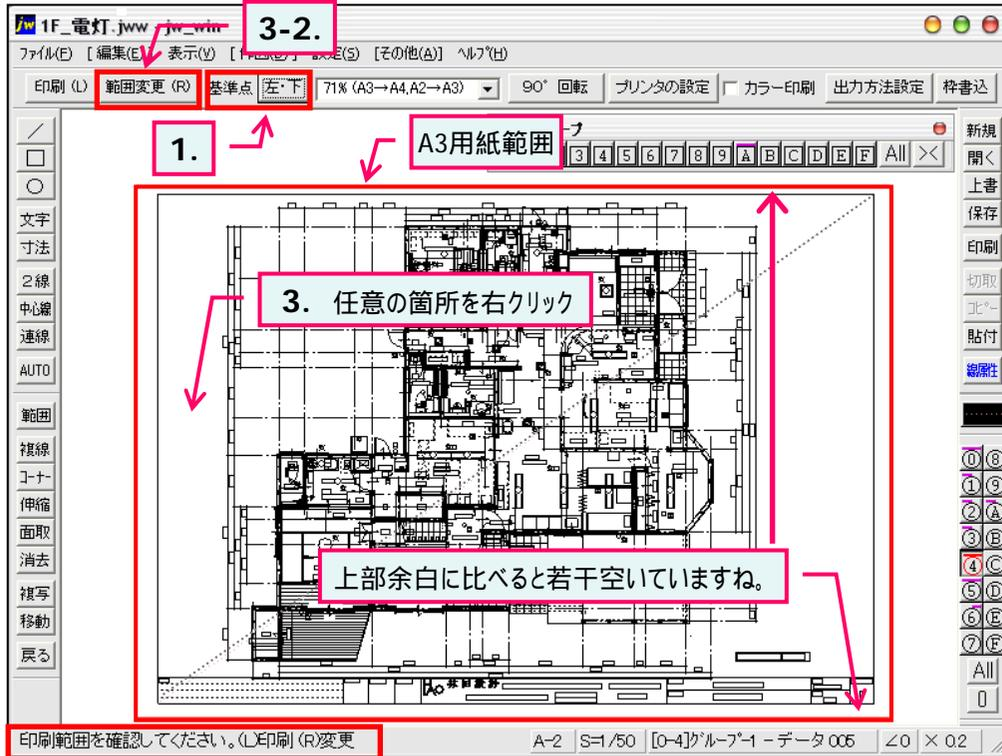
左図でも用紙範囲(印刷範囲)に対して図面枠の上下余白が違いますね。1枚の場合でしたらこの程度だと、そう気にならないのですが複数枚の場合は全枚数統一させたいですね。
